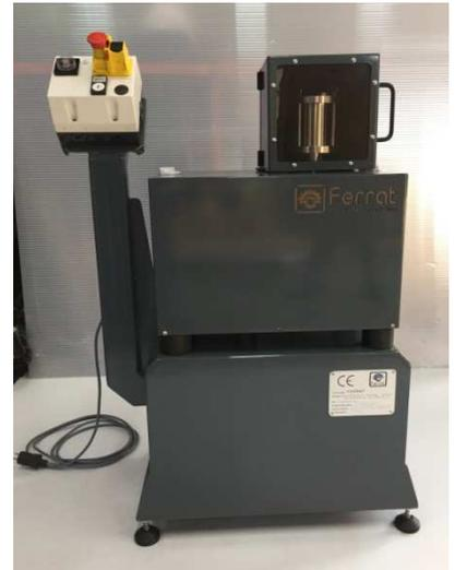
Broyeur à secousses de laboratoire
